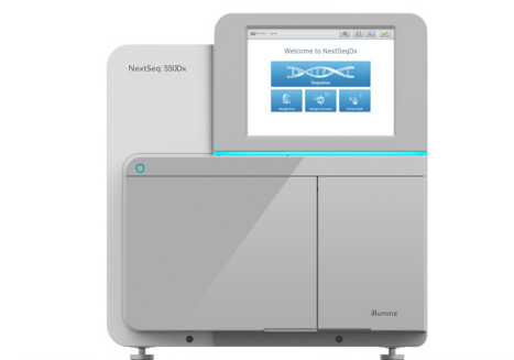
Abbildung 6: Das NextSeq 550Dx System: Das NextSeq 550Dx System (im Dx-Modus) wurde nach den Prinzipien der Designkontrolle entwickelt und unter Einhaltung der Richtlinien für gute Herstellungspraxis (GMP, Good Manufacturing Practice) hergestellt. Es unterstützt einen vollautomatischen TSO Comprehensive (EU)-Workflow von der Sequenzierung bis zur Erstellung des abschließenden klinischen Befunds.
