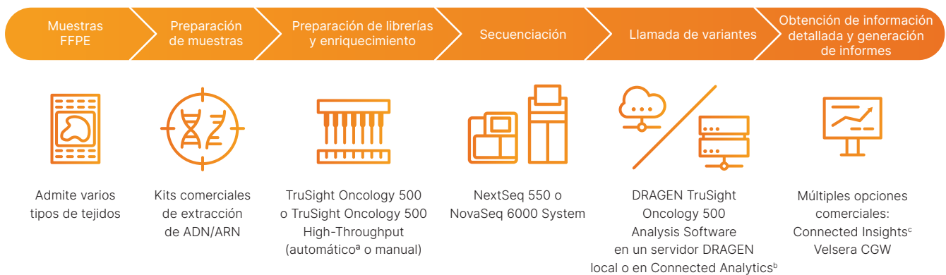
Figura 2: Flujo de trabajo de TruSight Oncology 500. TruSight Oncology 500 y TruSight Oncology 500 High-Throughput se integran en los flujos de trabajo de laboratorio actuales, desde los ácidos nucleicos hasta las llamadas de variantes en cuatro días.
