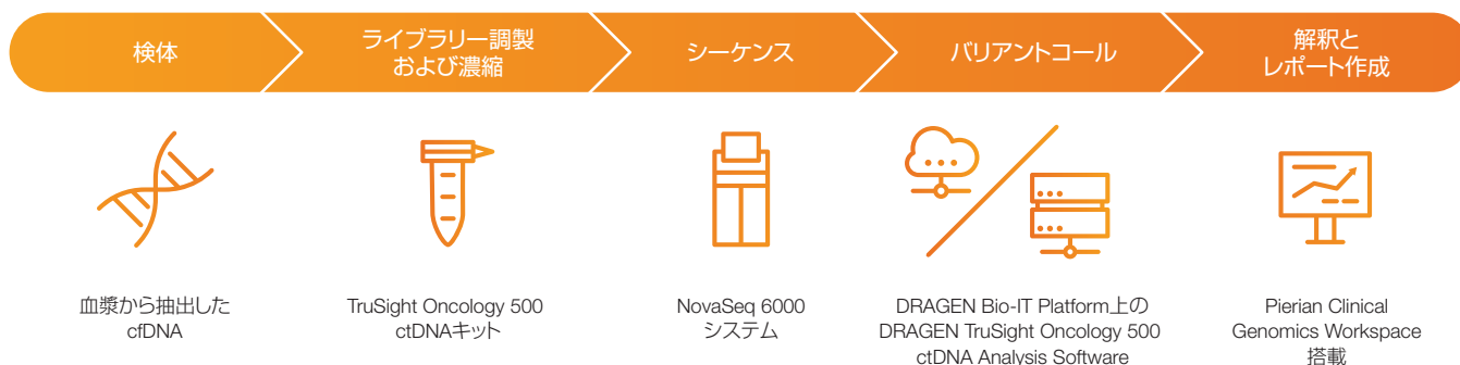
図2: TruSight Oncology 500 ctDNAアッセイのワークフロー: TruSight Oncology 500 ctDNAアッセイはラボの既存のワークフローに統合し、5日間でcfDNAからバリアントレポートを取得します。DRAGEN TruSight Oncology 500 ctDNA Analysis SoftwareはDRAGENサーバー上またはIllumina Connected Analyticsを介したクラウドに実行します。
