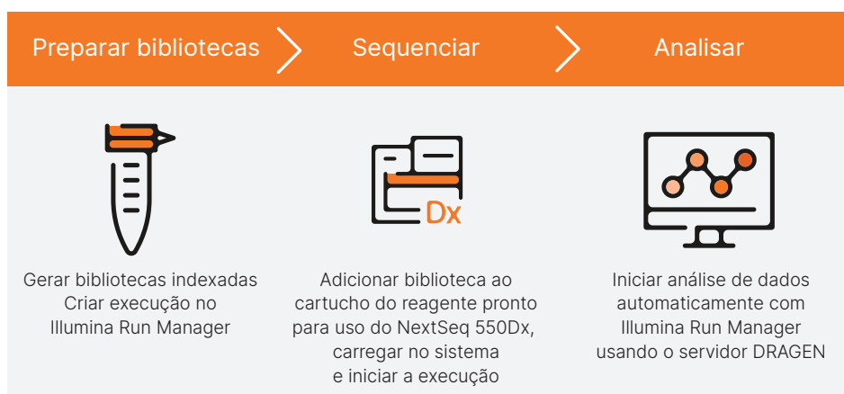
Figura 2: Processo de ensaio do NextSeq 550Dx em três etapas: o NextSeq 550Dx Instrument faz parte de um fluxo de trabalho integrado de três etapas. Relatórios detalhados dos resultados estão disponíveis com o ensaio do Illumina DNA Prep with Enrichment Dx.
