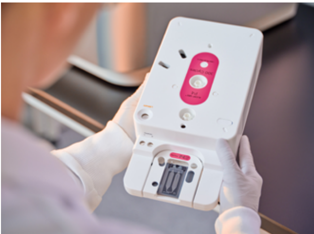
그림 4: NextSeq 1000 및 NextSeq 2000 시약 카트리지 — 시약, 유체, 폐기물 홀더가 포함되어 있어 시약 카트리지를 해동한 후 플로우 셀을 해동된 카트리지에 삽입하고 카트리지에 라이브러리를 로딩한 다음 조립한 카트리지를 기기에 장착하기만 하면 되는 통합된 카트리지
