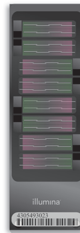
Figure 1 : Puce Infinium MethylationEPIC v2.0 BeadChip : la puce Infinium MethylationEPIC v2.0 BeadChip comporte > 935 000 CpG dans les régions amplificatrices, les corps de gène, les promoteurs et les îlots CpG.
