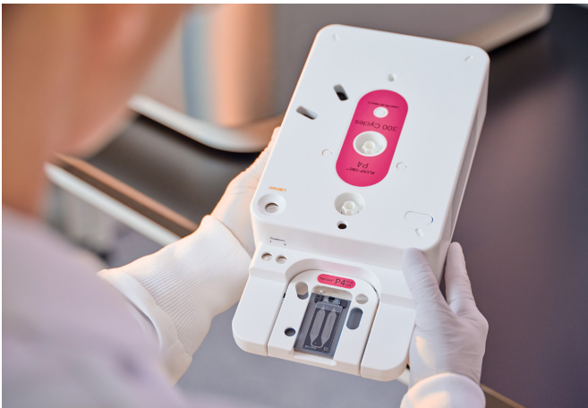
图 4：NextSeq 1000/2000 系列基因测序仪试剂卡盒——集成卡盒包括试剂、流体系统和废液容器。只需解冻试剂卡盒，将流动槽插入卡盒，加载文库，然后放入仪器即可。
