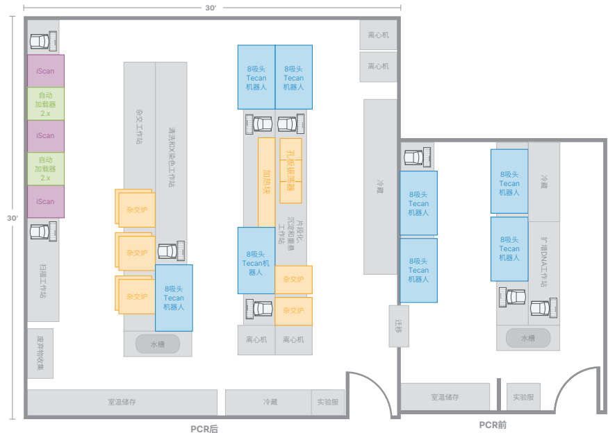
图3: Infinium XT生产规模基因分型的实验室布局示例 – 提供了每年处理1,000,000+个样本的实验室布局示例，包括：三台（8洗头）Tecan机器人、三台iScan™芯片扫描仪、两台AutoLoader 2.x装置和辅助实验室设备。该示例布局需要约1200平方英尺的面积。布局示意图未按比例绘制。
