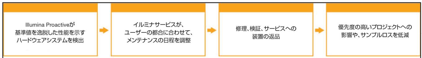
図1: ILLUMINA Proactiveが故障リスクを検出し、トラブルシューティングを容易にすることによってどのようにユーザーに利点をもたらすことができるかを示した事例: 恒常的なシステム性能データのモニタリングは光学系ハードウェアの故障リスクの予防的な検出を可能にします。ユーザーの優先度の高いプロジェクトを避けて計画したメンテナンスを行うことができます。時間、労力、およびサンプルに重大な損失が起こる可能性を回避します。
