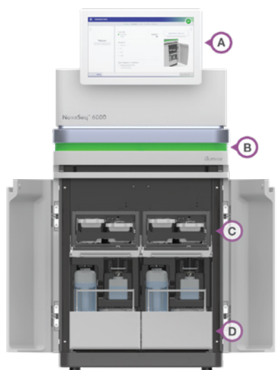
图 3: 简化的操作——NovaSeq 6000 系统的许多功能旨在简化基因组研究, 包括 (A) 直观的触摸屏界面, (B) 发光的 LED 显示流动槽状态, (C) 嵌入式的卡盒 (包含即用型试剂) 和 (D) 废液缸可轻松取出进行处理。
